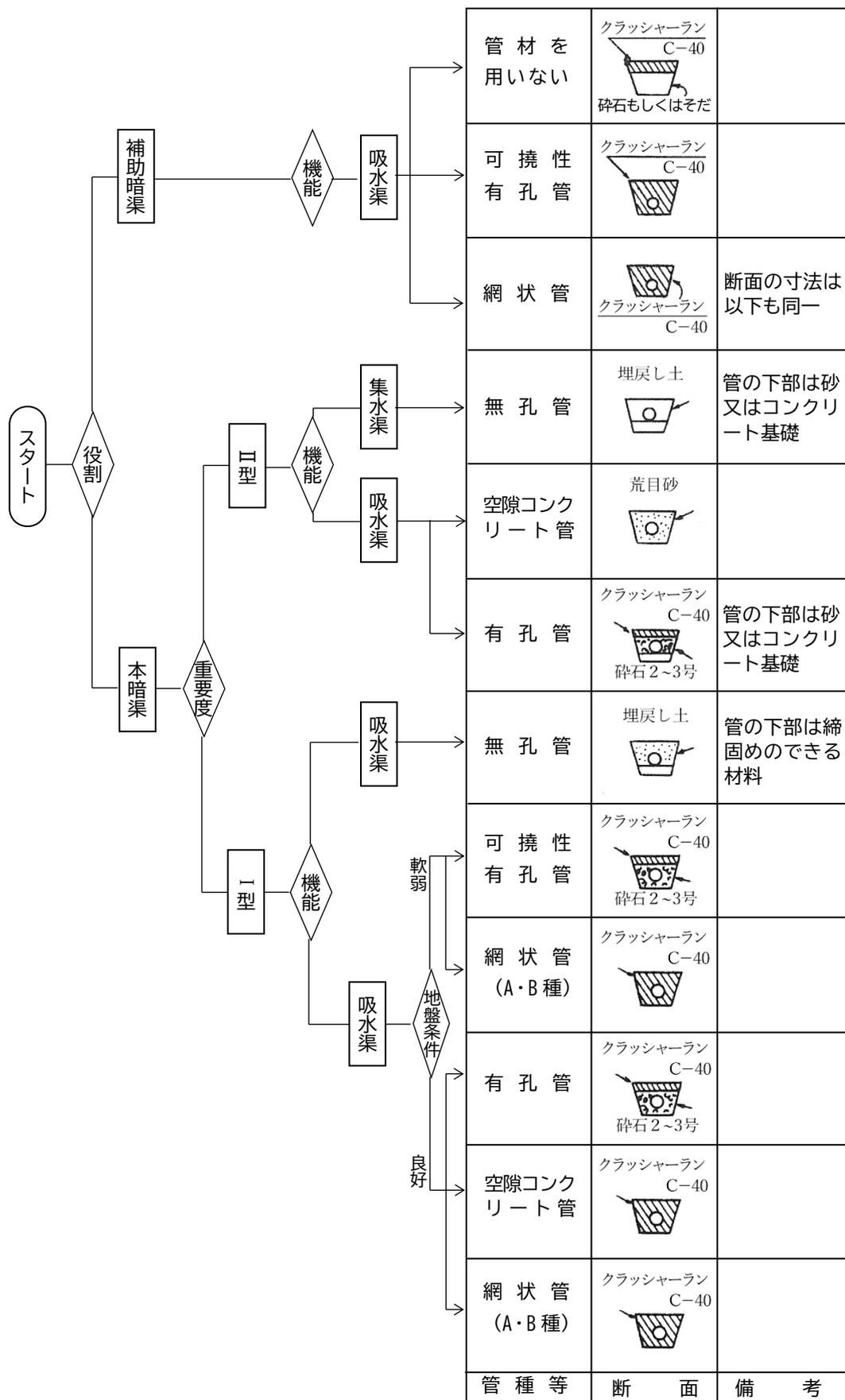
図 6(1)-11 地下排水暗渠の選定フローの例
