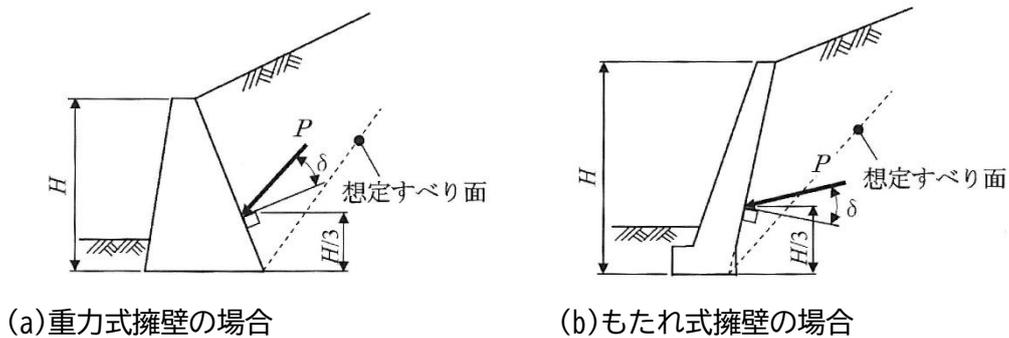
図3(3)-1 土圧の作用面（重力式擁壁等）
