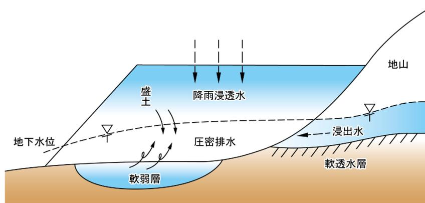
図 6(1)-7 地下水の各構成成分
