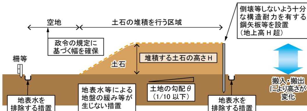
図 7(2)-2 堆積した土石の崩壊やそれに伴う流出を防止する措置
