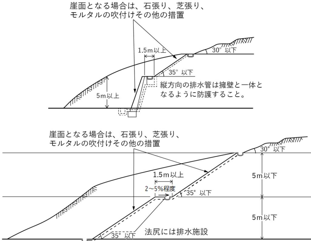
図1(6)-1 切土工（砂利、真砂土、関東ローム、硬質粘土その他これらに類するもの）
