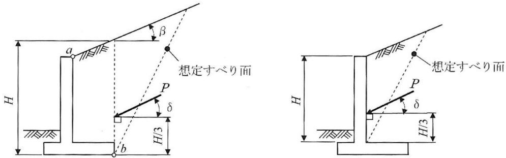
安定性の照査時及び底板の部材設計時の 縦壁の部材設計時における土圧作用面
