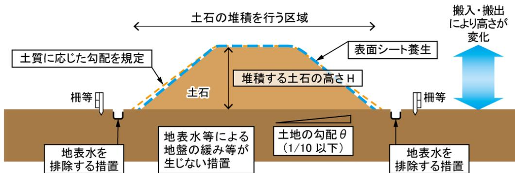
図 7(2)-3 堆積した土石の崩壊やそれに伴う流出を防止する措置
