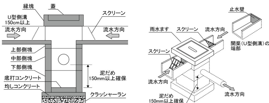
図 6(1)-1 排水工の標準構造図
