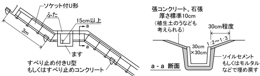
図 6(1)-6 U 型による縦排水工の構造図 (例)
