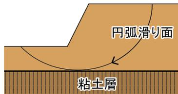
図 1(5)-2 円弧滑りが生じやすい地盤の一例
