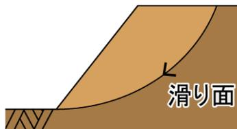
図 1(5)-4 円弧滑りの例（斜面先崩壊）
