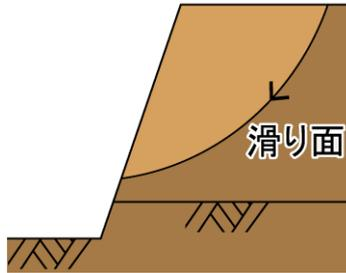
図 1(5)-5 円弧滑りの例（斜面内崩壊）
