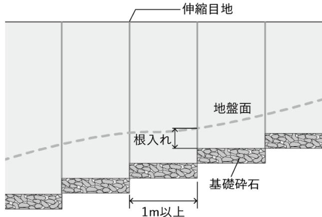
図 2(5)-1 斜面に沿って設置する擁壁
