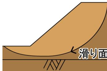
図 1(5)-3 円弧滑りの例（底部崩壊）
