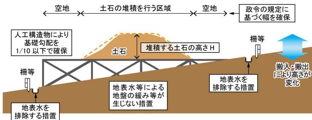
図 7(2)-1 堆積した土石の崩壊やそれに伴う流出を防止する措置
