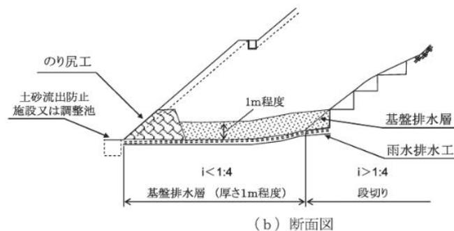
図 6(1)-12 基盤排水層の設置例
