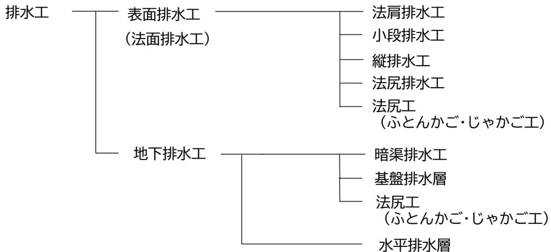
[排水工（管渠）の構造]
