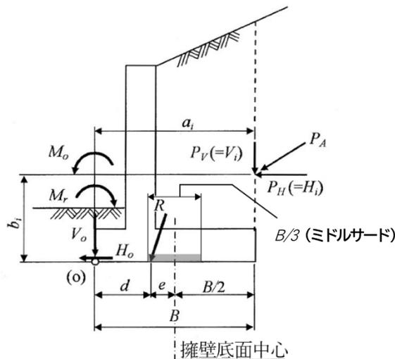
図 3(3)-6 合力作用位置の求め方
