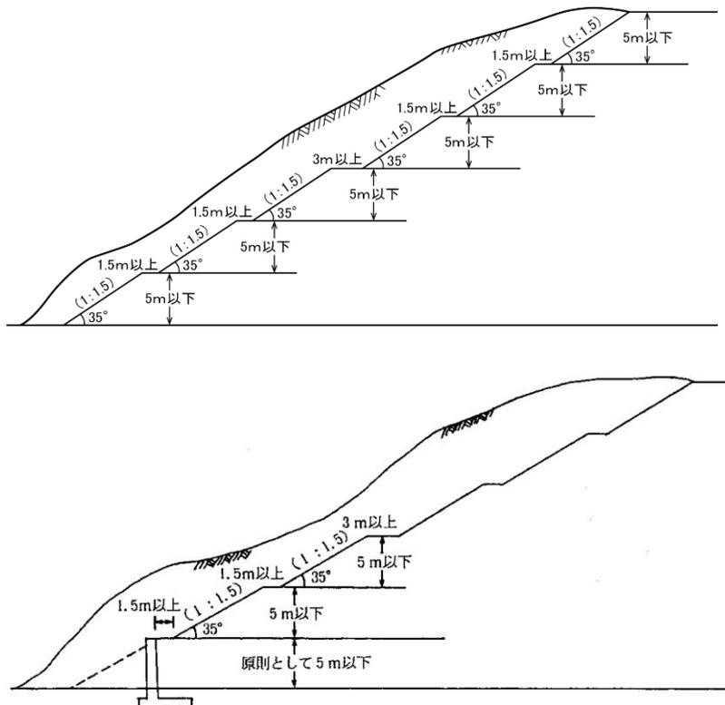
図1(6)-2 長大法（切土）の参考断面図（法尻に鉄筋コンクリート擁壁を設置する場合）
