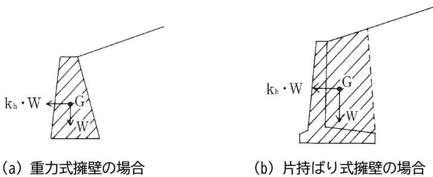
図 3(3)-5 地震時慣性力の考え方
