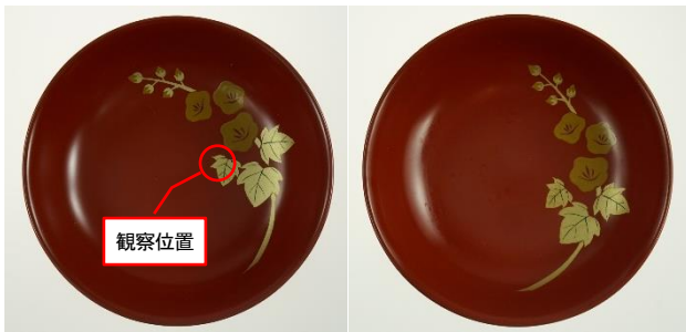
(左：試験前、右：試験後) 図3 消蒔絵が施された実証試験前後の手塩皿
