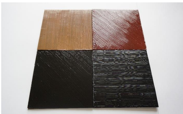
図13 水添加漆を使用した刷毛目塗のパネル
