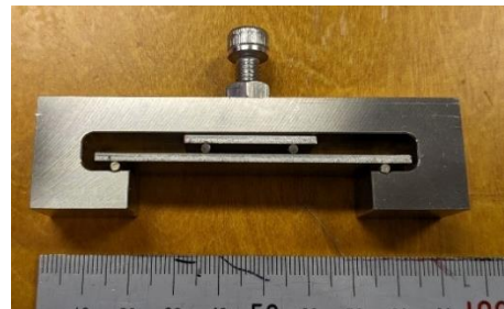
図3 応力腐食曲げ試験片の外観写真
