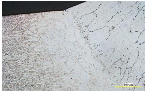
図 2 1 浸漬試験後 SUS821 溶接材の断面観察写真 (熱影響部拡大図)
