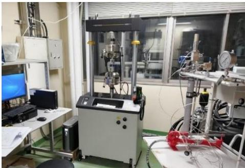
図10 中空試験片式高圧ガス疲労試験機の装置外観
