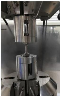
図11 試験片固定部写真
