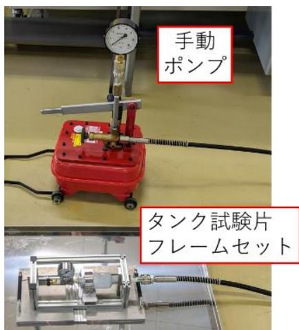
図6 手動ポンプとタンク試験片フレームセット
