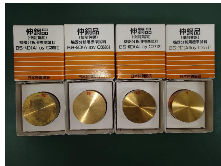
快削黄銅標準試料(日本伸銅協会製)
