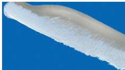
着氷によるブレード破損、発電停止
