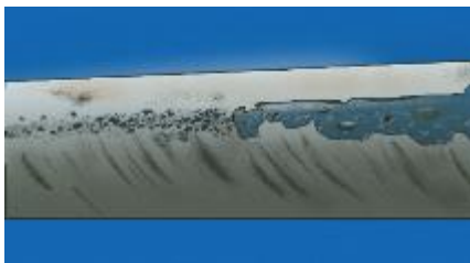
エロージョンによるブレード表面劣化
