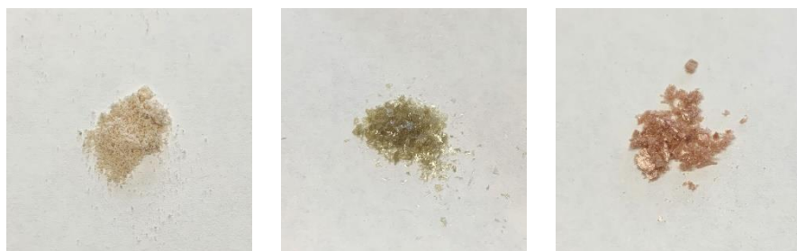
図1 漆に添加した酵素の外観 左：LCC（ラッカーゼカワラタケ由来） 中：BLC（カタラーゼウシ肝臓由来） 右：HRP（ペルオキシダーゼ西洋わさび由来）
