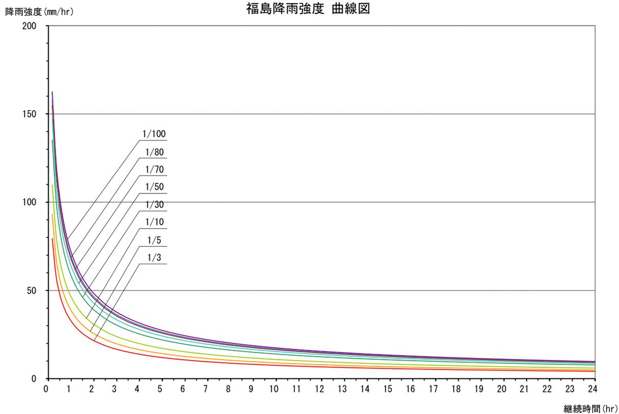
図 5.3.1 降雨強度曲線図 (福島地方気象台)
