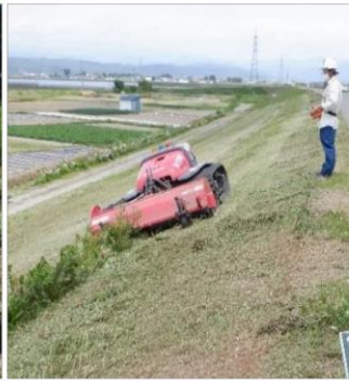
大型ラジコンによる遠隔式除草
