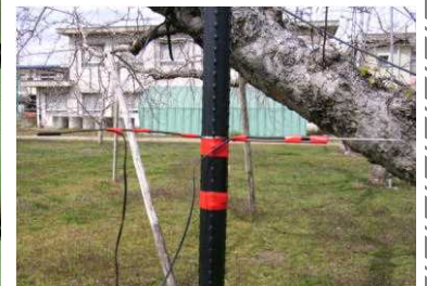
図2 温度センサーの設置方法
