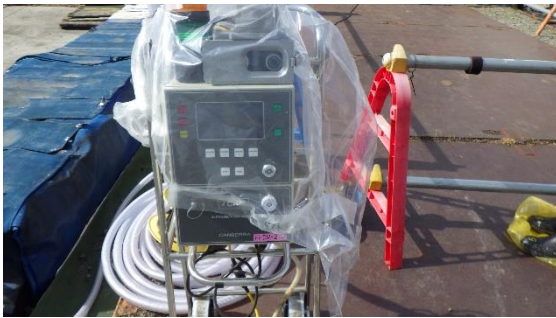
(写真5-1) 作業エリア境界の北側のダスト濃度を測定しているダストモニタ。 ※ 高温焼却炉建屋北東側に設置
