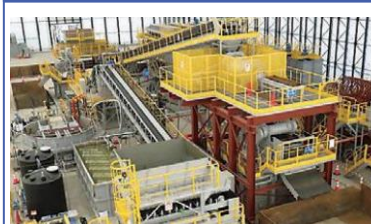
除去土壌を写真の機械で粒径別にふるい分けすることにより、放射能濃度の高いシルトや粘土と濃度の低い礫や砂に分離する技術。
