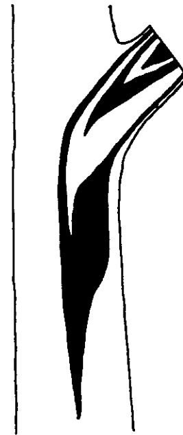
図-4 樹体縦断面における心材腐朽の 進展模式図
