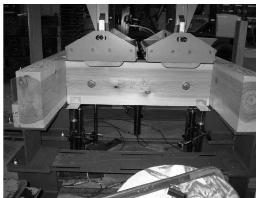
写真-2 試験状況 梁-梁接合
