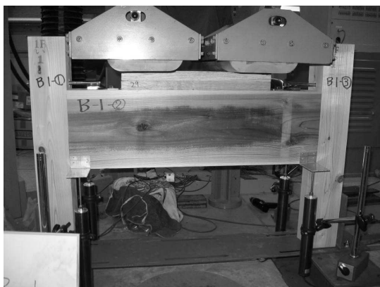
写真-1 試験状況 柱-梁接合
