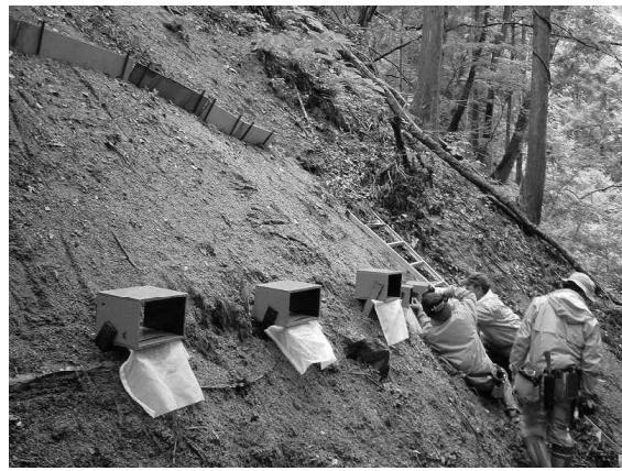
土砂受け箱による移動土砂量の測定
