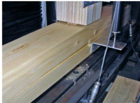
写真1 横木の割裂 (込み栓2本間隔20mm)
