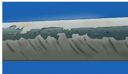
エロージョンによるブレード表面劣化
