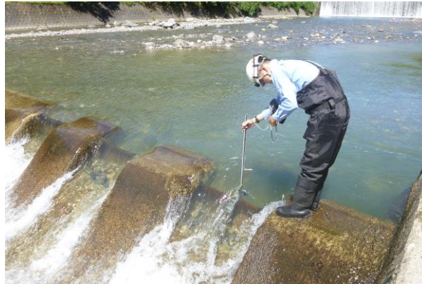
R4小水力ポテンシャル調査（左）落差計測 （中）流量測定 （右）河川の規模、現況の調査
