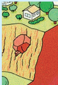
②斜面に浮き石
