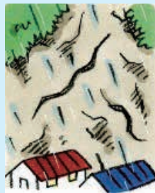
①斜面に亀裂
