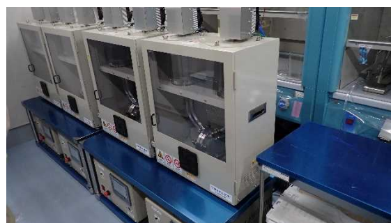
(写真2-1) 電解濃縮装置の状況
