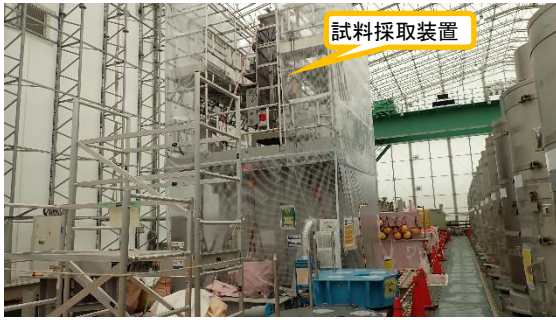
(写真4) 試料採取装置 (キュリオン及びサリー使用済吸着塔 内吸着材採取用) (西側から撮影)
