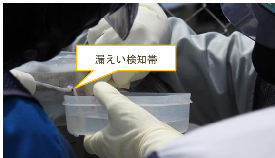
(写真 2 - 5) 漏えい検査の状況 漏えい検知帯を水に接触させている 様子
