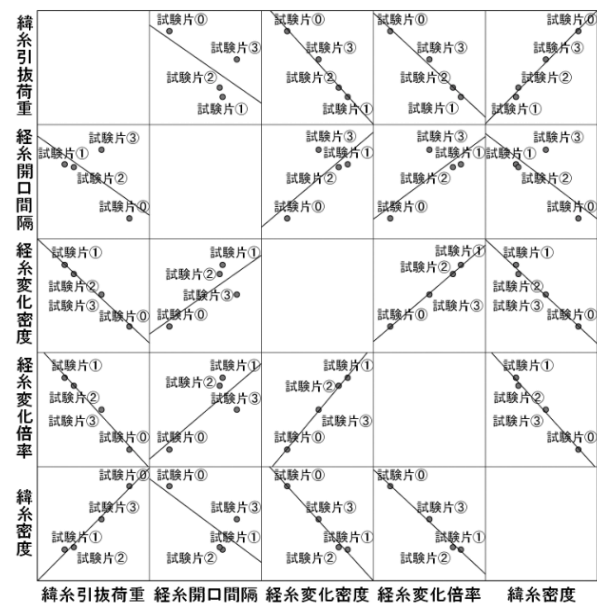
図 3 平織組織における局所的経糸の高密度化と設計条件の相関図
