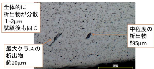
図15. RET試験前サンプルのマイクロ組織写真
