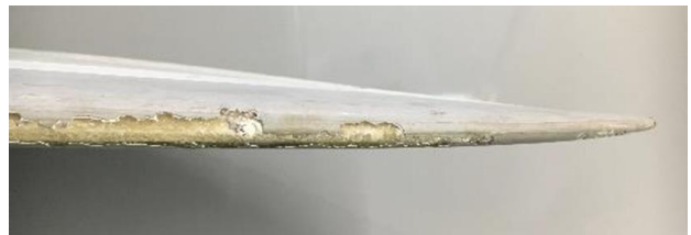
図3 レイン・エロージョンの発生例 3)
