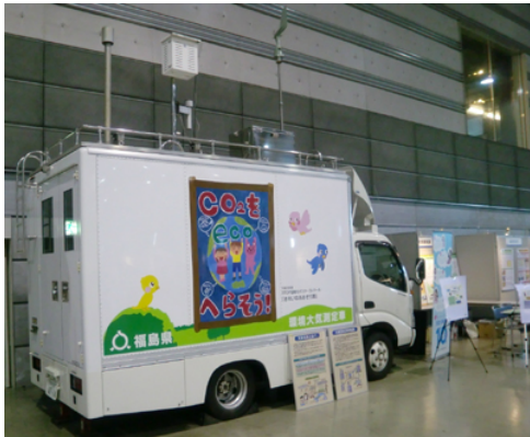
Fig. 2 環境大気測定車の外観
