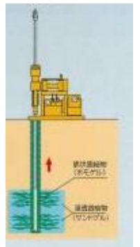
地盤注入(薬液等)
