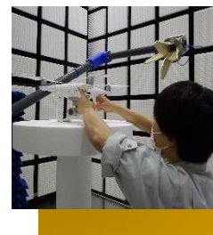
ドローンの無線性能評価の様子
