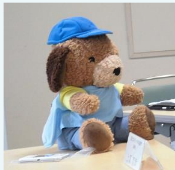
▲介護支援コミュニケーションロボット「ふくちゃん」約5千の言葉を認識
