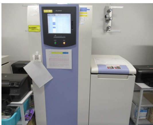
液体シンチレーションカウンタ (型式 : LSC-LB7)
