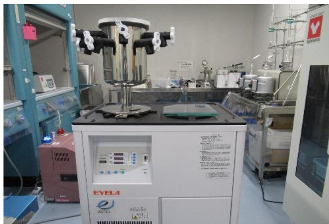
真空凍結乾燥装置
