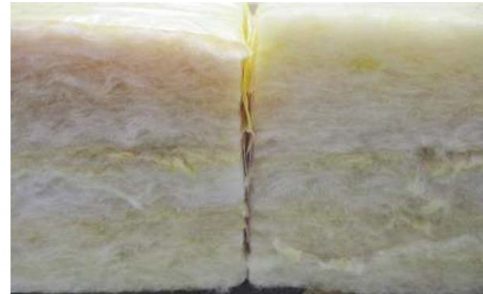
写真 断熱材試作品の外観(左:PVガラス、右:窓ガラス)
