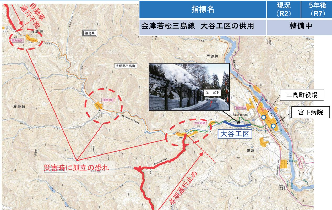
図4-4 孤立集落の発生を回避する道路整備（会津若松三島線 大谷工区）
