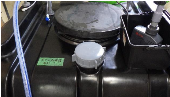
(写真 2 - 6) オゾン処理を行う槽
