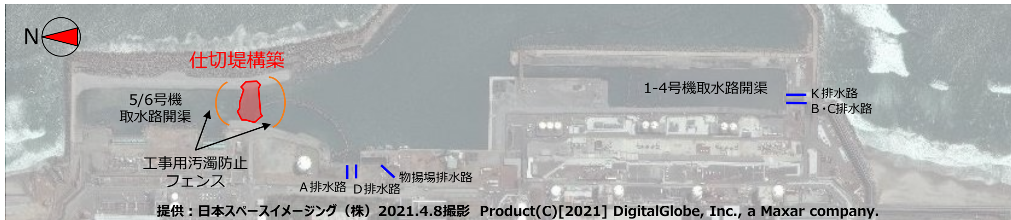
図 仕切堤構築時の工事用汚濁防止フェンス設置イメージ
