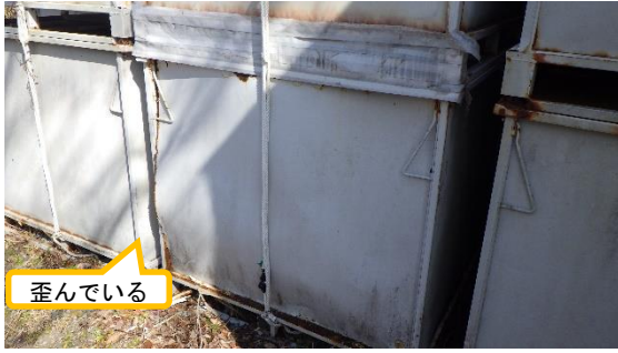
(写真4-2) 劣化コンテナの一例②
