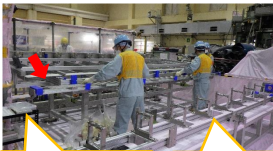
(写真3-2) 燃料棒が所定の位置に来たら、スミヤ測定を実施する。
