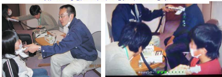
NaI(Tl)サーベイメータを頸部に密着させて測定 (写真右はバックグラウンド測定の様子)
