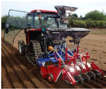
図1 畝立同時多条播種機
