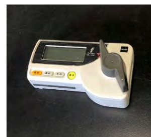
図 穀類水分計、米麦水分計によるエゴマの水分率推定
