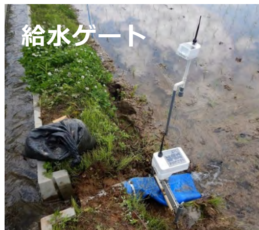
図1 実証水田に設置した自動水管理システム
