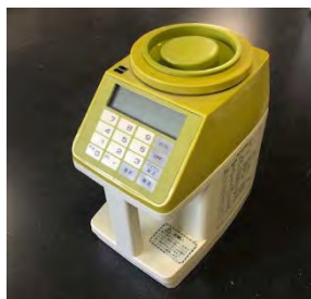
図 穀類水分計、米麦水分計によるエゴマの水分率推定
