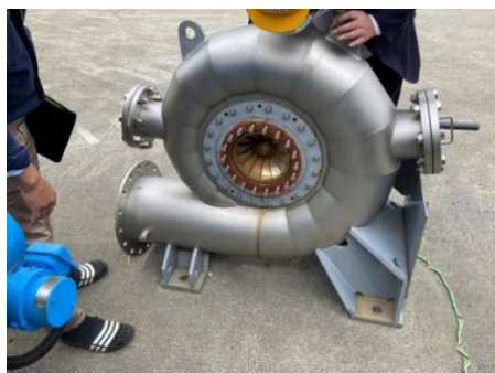
県内企業による小水力発電用水車の製造（提供：朝日機工㈱）
