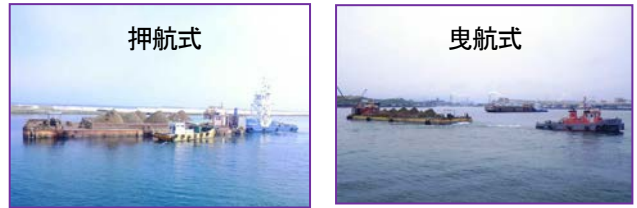
写真-13 土運船による運搬状況
