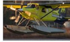
水上飛行機を改造して750馬力の電動推進システムを搭載@カナダバンクーバー (出典)36Kr Japanニュース <https://36kr.jp/50837/>
