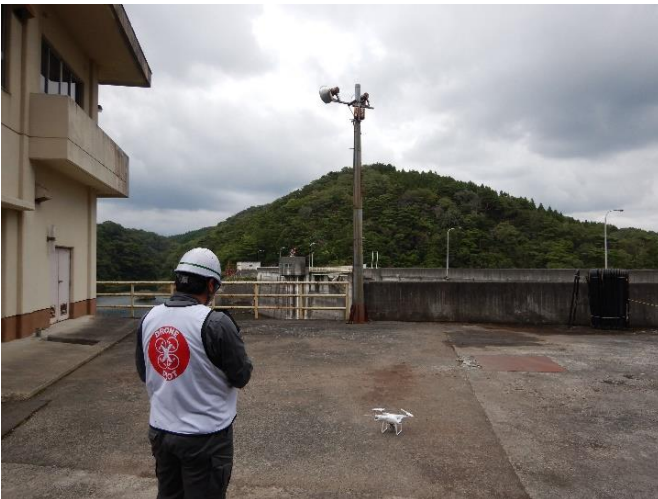
空中ドローンによる堤体コンクリートの調査
