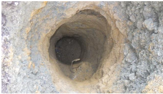
(写真 2 - 3) 穴の底部の状況 (地下水や氷は確認されない。)
