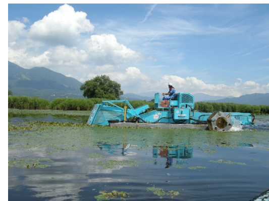
水生植物刈取船による刈取り
