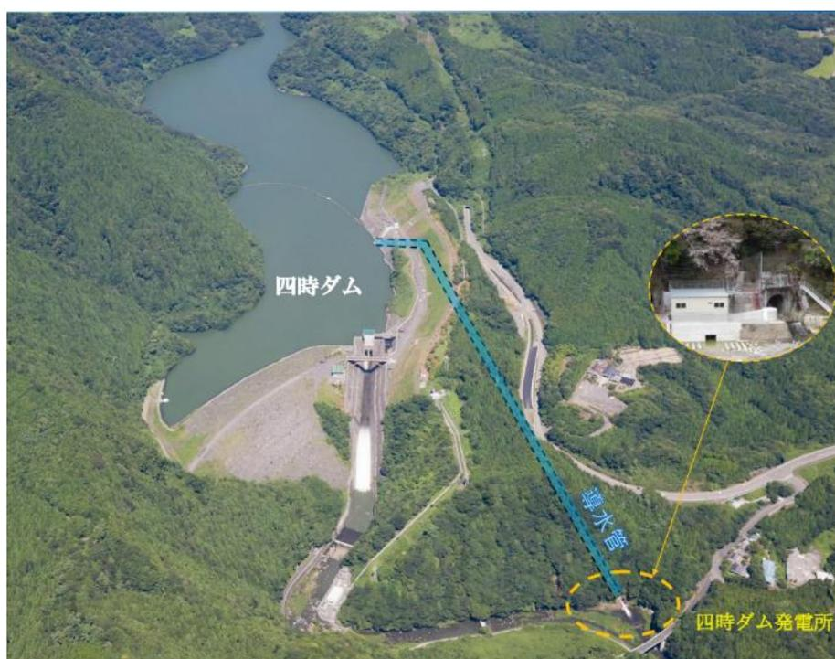
図：四時ダム発電所(470kW)
