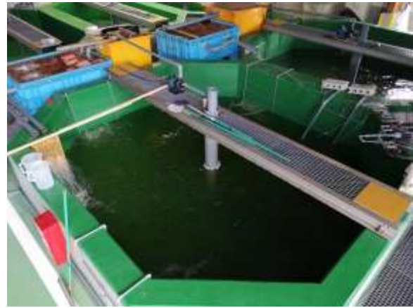
水産種苗の生産技術開発 (アユの完全閉鎖循環飼育システム)
