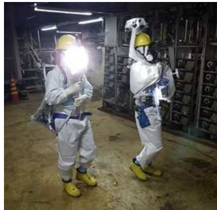
照明とウェアラブル型3Dスキャン装置 (4号機におけるモックアップの様子)
