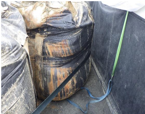
フレコン固定状況
