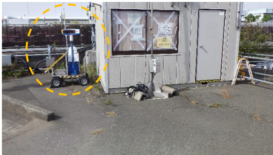
(写真3-2) 5/6号機南側に設置されている 線量表示器の状況
