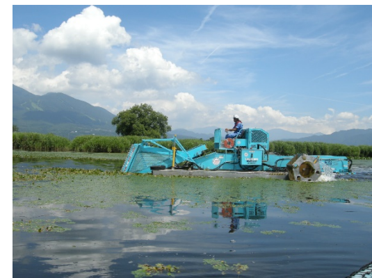
水生植物刈取船による刈取り
